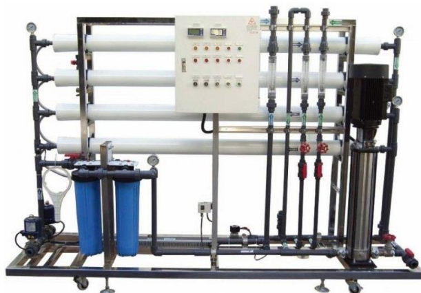
Figura 3-76 Componentes básicos de un sistema de ósmosis inversa
