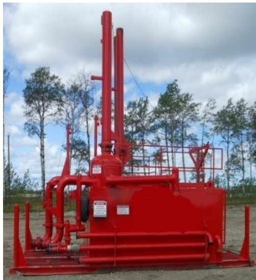
Figura 3-60 Quemadero para perforación y completamiento
