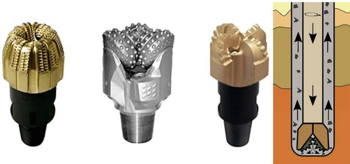
Figura 3-61 Diferentes tipos de brocas de perforación (izq). Mecanismo de perforación con rotación y circulación
