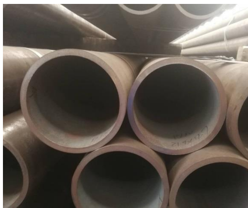
Figura 3-63 Esquema simplificado de estado mecánico final del pozo (izq). Imagen de tubería de revestimiento mostrando el espesor de pared (der)
