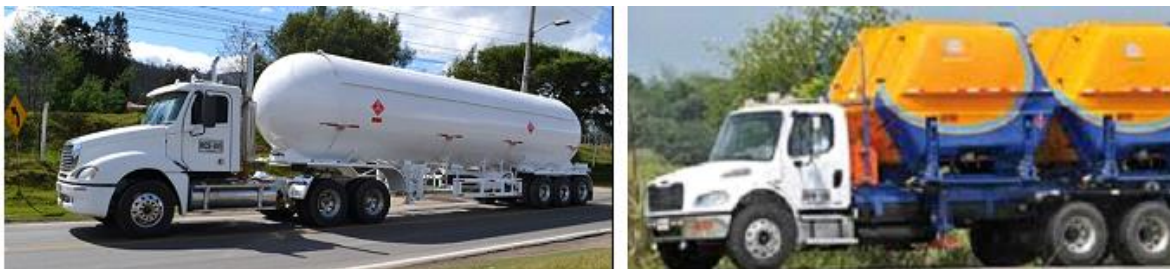
Figura 3-91 Vehículos para transporte de gas: carrotaque cisterna (izq); gasoducto virtual (der)
