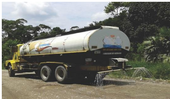
Figura 3-73 Carrotanque modificado con flauta de descarga para realizar riego en vías
