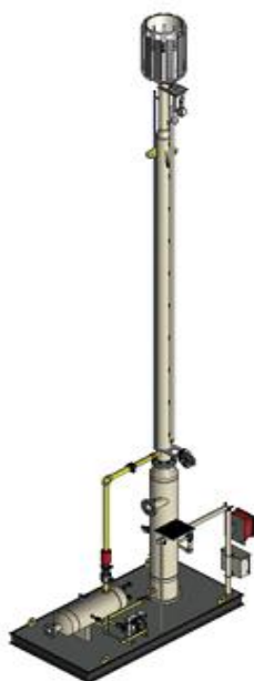
Figura 3-82 Diseño conceptual y ejemplo de una tea en funcionamiento
